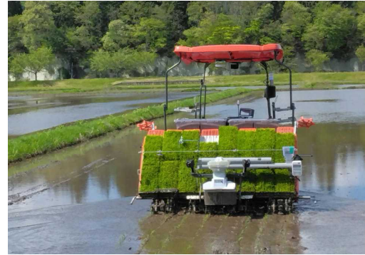
<図>自動操舵トラクタによるえだまめ播種作業
