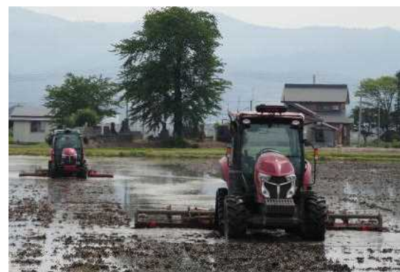
<図>自動走行トラクターによる代掻き作業(3.6ha大区画)
