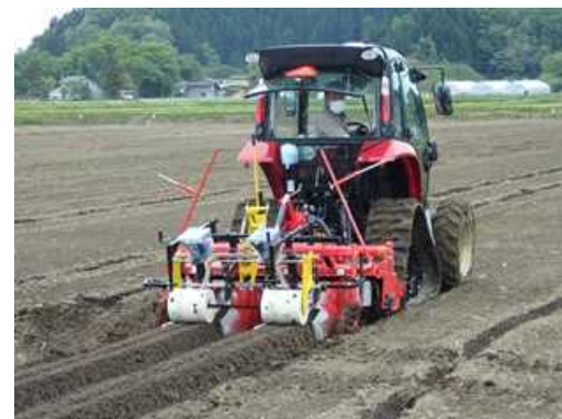
<図>自動操舵トラクタによるえだまめ播種作業
